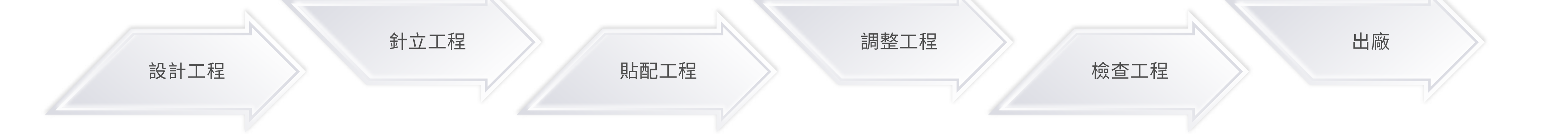
晶圓探針卡製造流程
